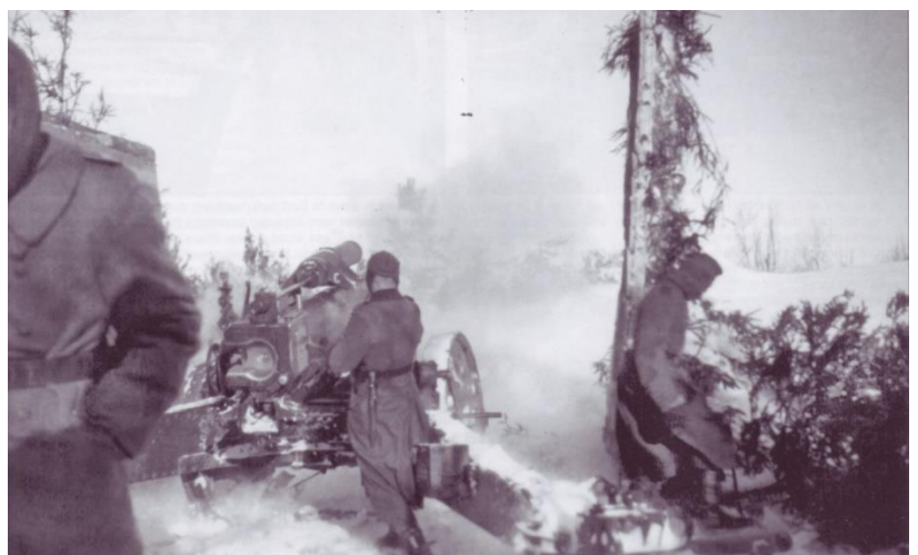
Eine 15cm Haubitze feuert. Beachten Sie, dass auf beiden Seiten hohe Holzplanken angebracht sind, die an den Außenseiten mit Vegetation verdrahtet sind, ähnlich wie bei einem "Ansitz" für Jäger. Wenn sie nicht feuerte, wurden diese Abdeckungen über der Haubitze heruntergelassen, um sie vor der Beobachtung aus der Luft zu verbergen und vor Schnee zu schützen. Die Bezeichnung des Geschützes innerhalb der Batterie, "C", ist in weißer Farbe auf der Halterung des Rückstoßzylinders angebracht.
